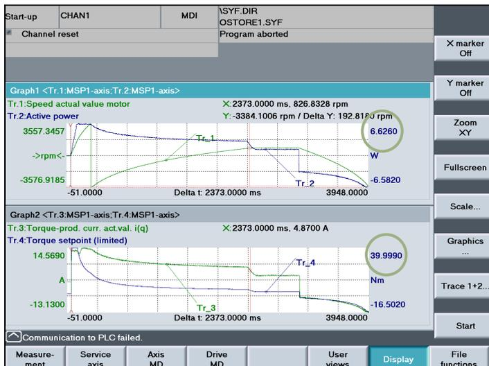
跟踪结果显示从0到9000 rpm 的加速时间为2.3秒以及与电机S6曲线相关的扭矩和功率值。
