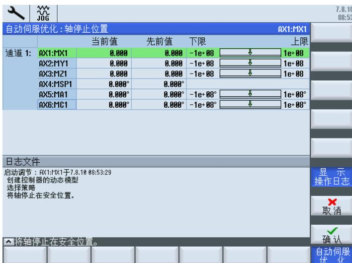
按“确认”后，下图中的对话框将会出现，要求用户在机床控制面板上按下“Cycle Start”键。系统执行各种动作期间，该对话框将多次出现。保持按下机床控制面板上的“Cycle Start”直到系统显示下页中的窗口。
